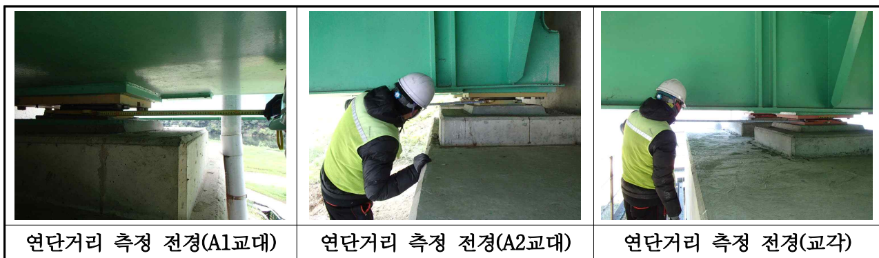
【사진 3.3.14】 연단거리 측정 전경
