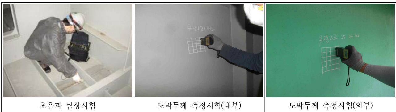
【사진 3.5.1】 강재 비파괴시험 전경
