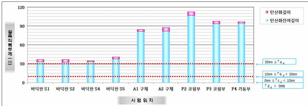
【그림 3.4.17】 탄산화 깊이 측정결과(부산)
