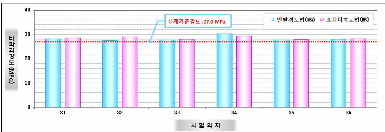
【그림 3.4.15】 상부구조(바닥판하면) 평균압축강도 추정결과(부산)
